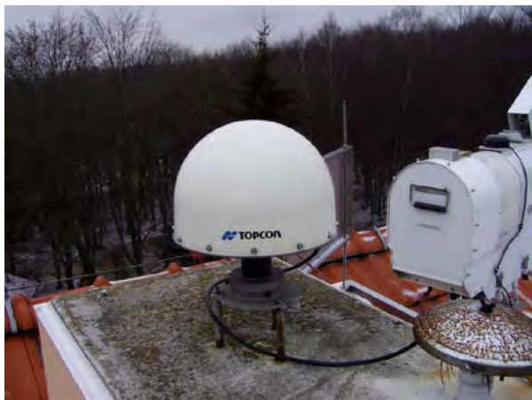
Obr. 9 – Anténa Topcon CR.G3 přijímače Topcon NetG3 na permanentní stanici GOPE. Vpravo je radiometr vodních par.
